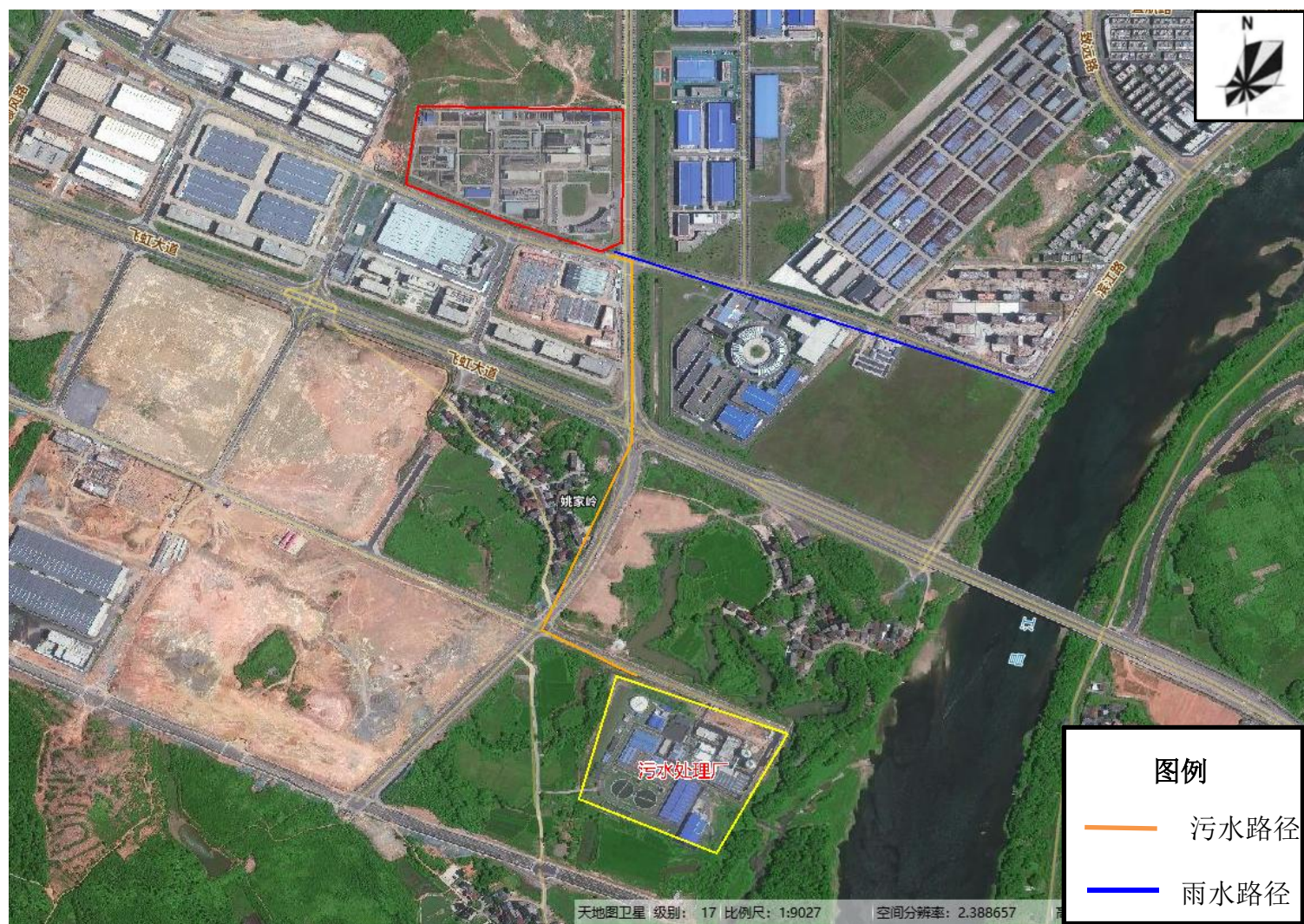
图 2.6-4 污水和雨水排放途径图
